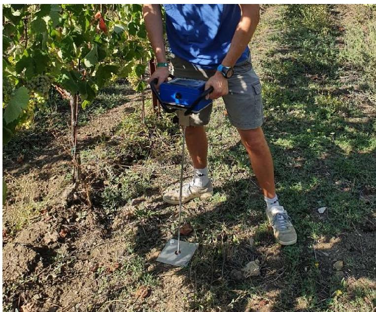
*Fig.8. Esecuzione di una prova penetrometrica per la determinazione della resistenza a penetrazione del suolo.*
