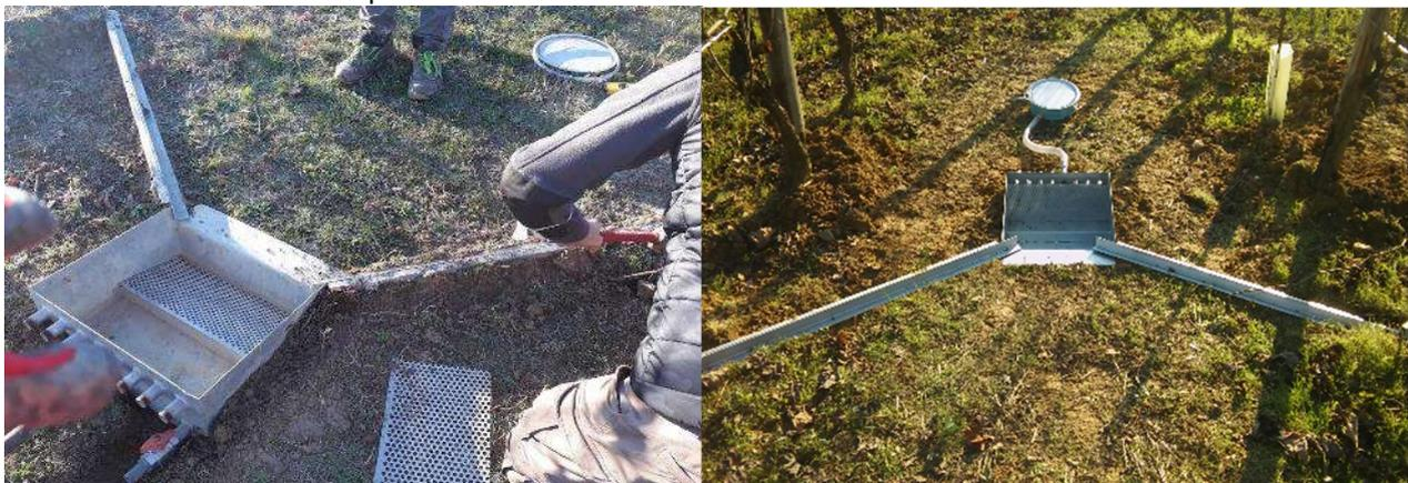
*Fig. 4: installazione vasche per microplot per monitoraggio deflusso/erosione.*
