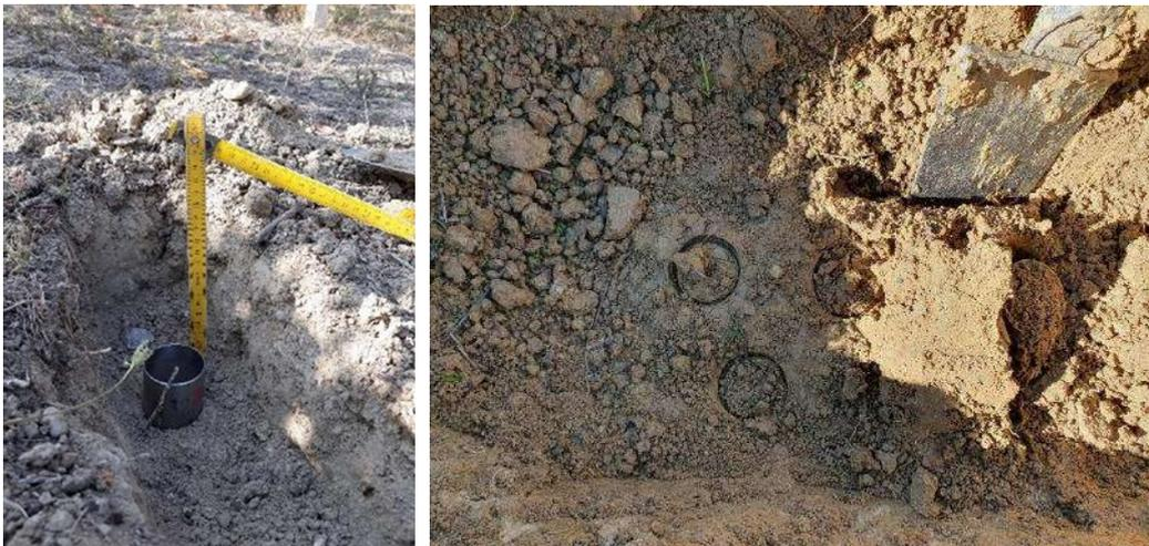
*Fig.7. Prelievo di campioni in vigneto per la misura della densità del suolo apparente e contenuto idrico del suolo.*
