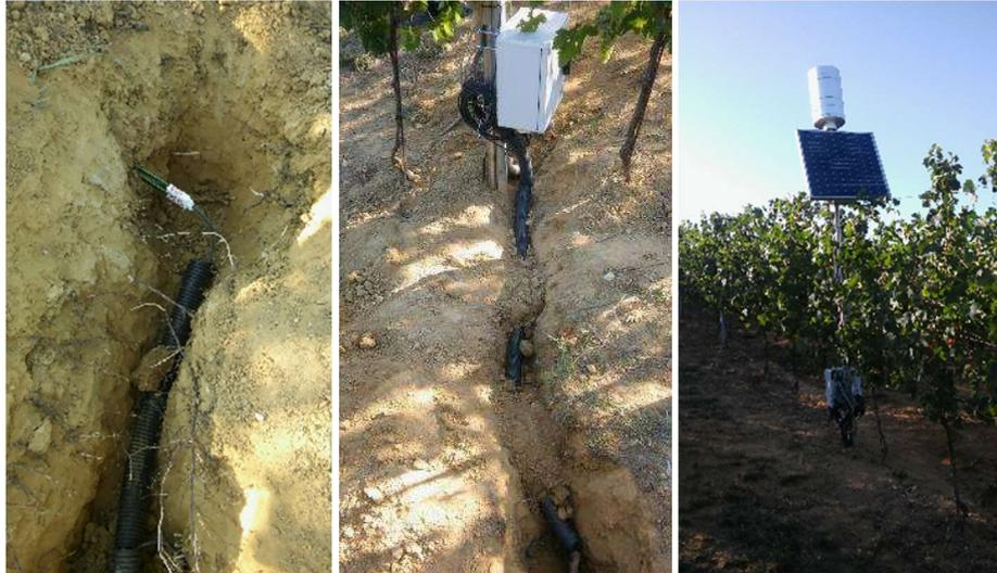
*Fig.6. posizionamento dei sensori per la misura dell'umidità del suolo collegati a datalogger per la trasmissione in remoto.*
