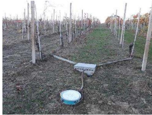
*Micro-plot installato tra i filari gestiti con inerimento permanente, permette la raccolta e misura delle acque di deflusso e sedimenti asportati.*
