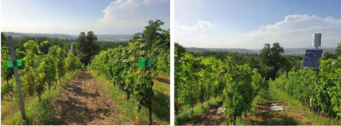
*Due immagini del vigneto di Rocchetta Tanaro prima del diserbo del sottofila. A destra si vede il pluviometro installato in vigneto e le vasche di raccolta delle acque di deflusso di tipo Gerlach installate nell'interfila.*
