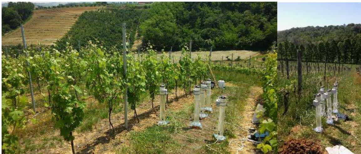
*Fig.5. Esecuzione di test di infiltrazione per la determinazione della conducibilità idraulica saturata.*
